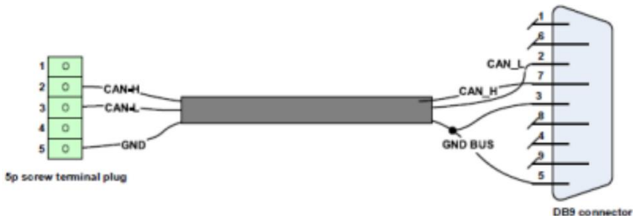
Рис. 1.18 Схема подключения CANopen модуля.
