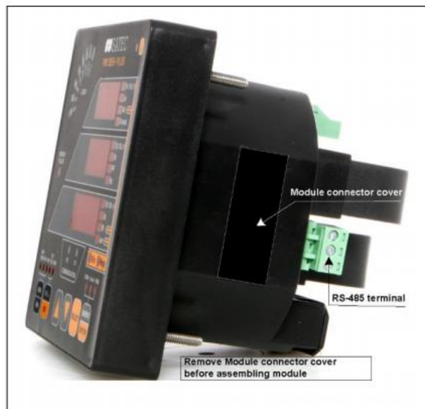
Рис. 2.3 Подключение модуля 12DIOR к РМ 130
