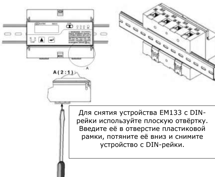
Рис. 1-4. Монтаж EM133/EM132/EM131 на рейку DIN.
