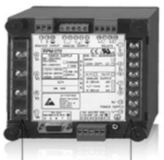
Рисунок 2 - Места пломбирования от несанкционированного доступа, показаны стрелками
