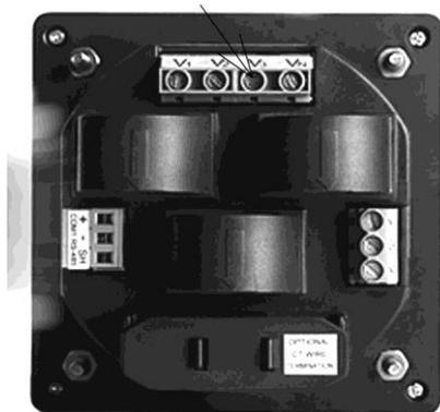
Рисунок 2 - Место пломбирования от несанкционированного доступа (показано стрелкой)
