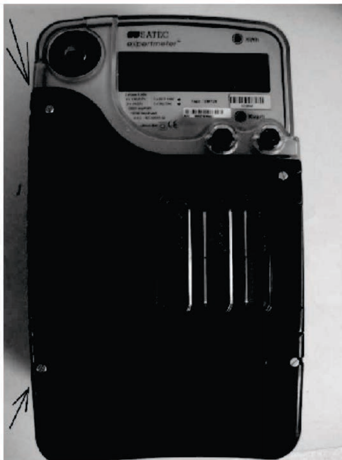
Рисунок 2 - Крепёжные винты (показаны стрелками), позволяющие пользователю осуществлять пломбирование счётчика
