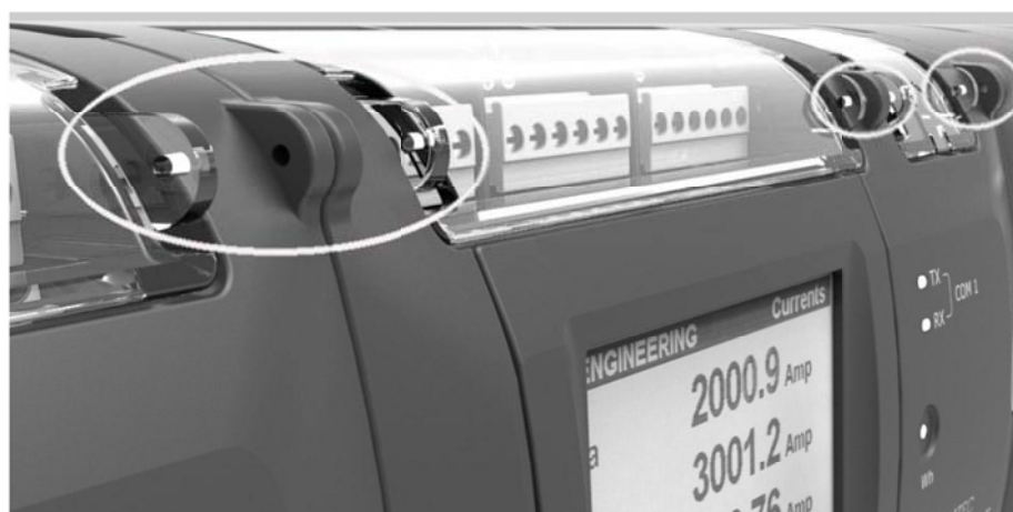
Рисунок 2 – Места пломбировки от несанкционированного доступа
