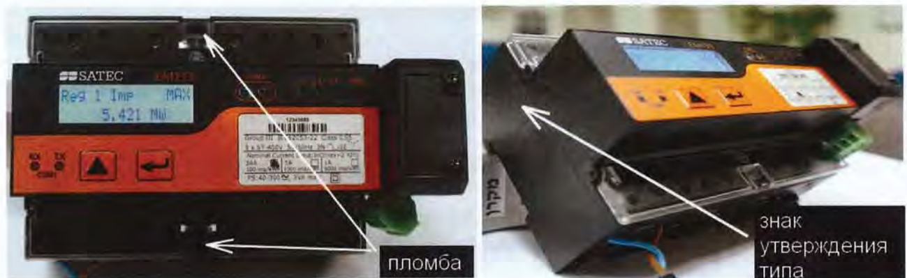
Рисунок 1. Внешний вид счётчика, стрелками показано место нанесения знака утверждения типа и место для пломбирования.
